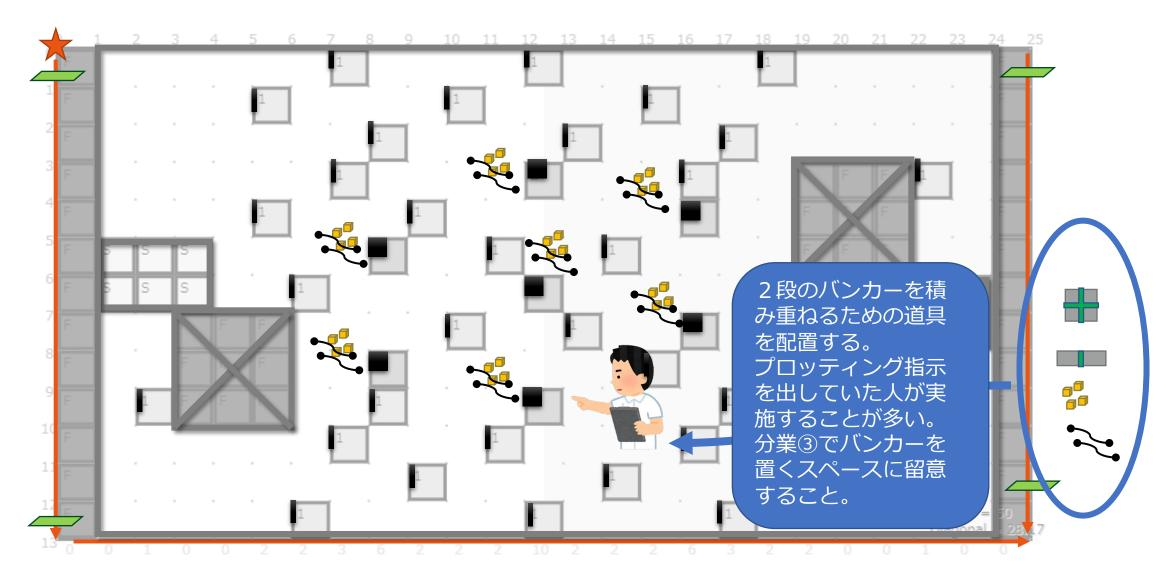
分業③-1 バンカーと筋交いを仮置き(多いほどよい) バンカーと筋交い(※)を仮置きしていく。 効率良く移動するため、並べ終わるまでバンカーは自 立させない。**バンカーを配置してから一斉に立てる。** フィールドの奥から順に行う。 バンカー本体はテープの右下に寝かせて仮置きする。
